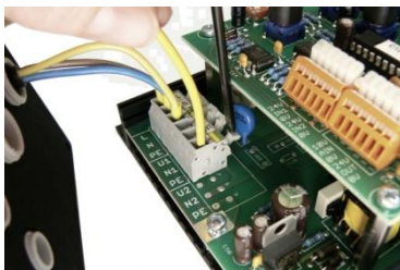
рис. 8 – присоединение кабелей к клеммам
