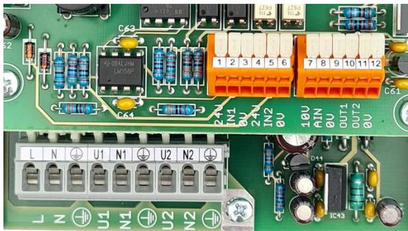
Nachdem Sie die externen elektrischen Teile des Reglers an die Klemmleiste angeschlossen haben (Abb. 6), setzen Sie den Teil mit den Durchgängen und die obere Abdeckung wieder zusammen.
