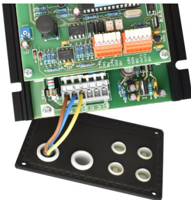
Abb. 5 – Demontage des Teils mit Durchgängen
