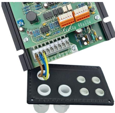
obr. 5 – demontáž časti s vývodkami
