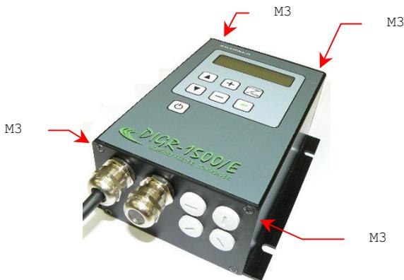
рис. 5 – снятие крышки
