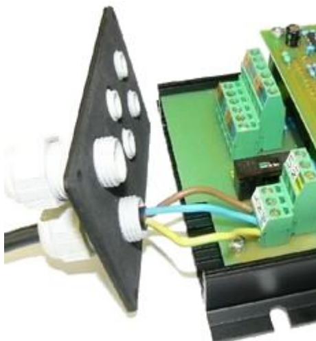
obr. 6 - demontáž části s vývodkami
