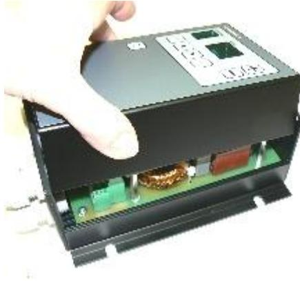
Für den besseren Zugang zur Klemmleiste empfehlen wir auch die Demontage des Teiles mit den Kabel-Durchgängen (Abb. 6).
