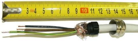
*рис. 8 – присоединение кабелей к клеммам*
