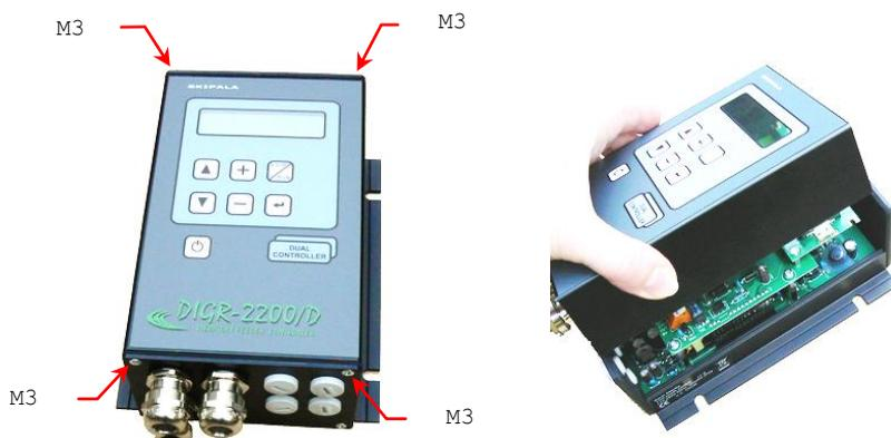
Для обеспечения лучшего доступа к сборке зажимов рекомендуем демонтировать и часть с выводами (рис. 5).
