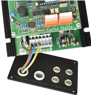
Abb. 5 – Demontage des Teils mit Durchgängen
