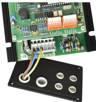
obr. 5 - demontáž části s vývodkami
