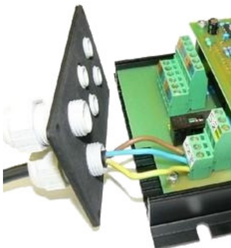
рис. 6 – демонтаж части с выводами
