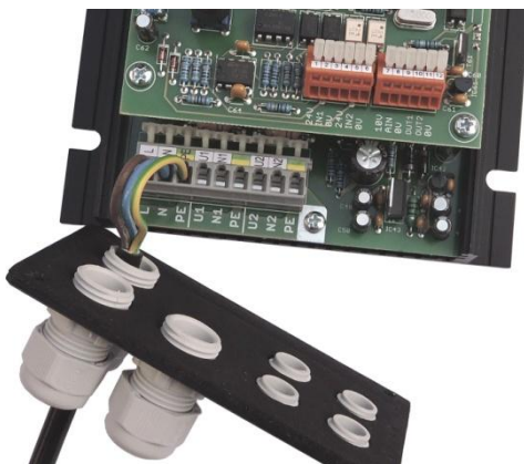
obr. 5 - demontáž části s vývodkami
