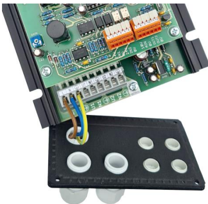
obr. 5 - demontáž části s vývodkami
