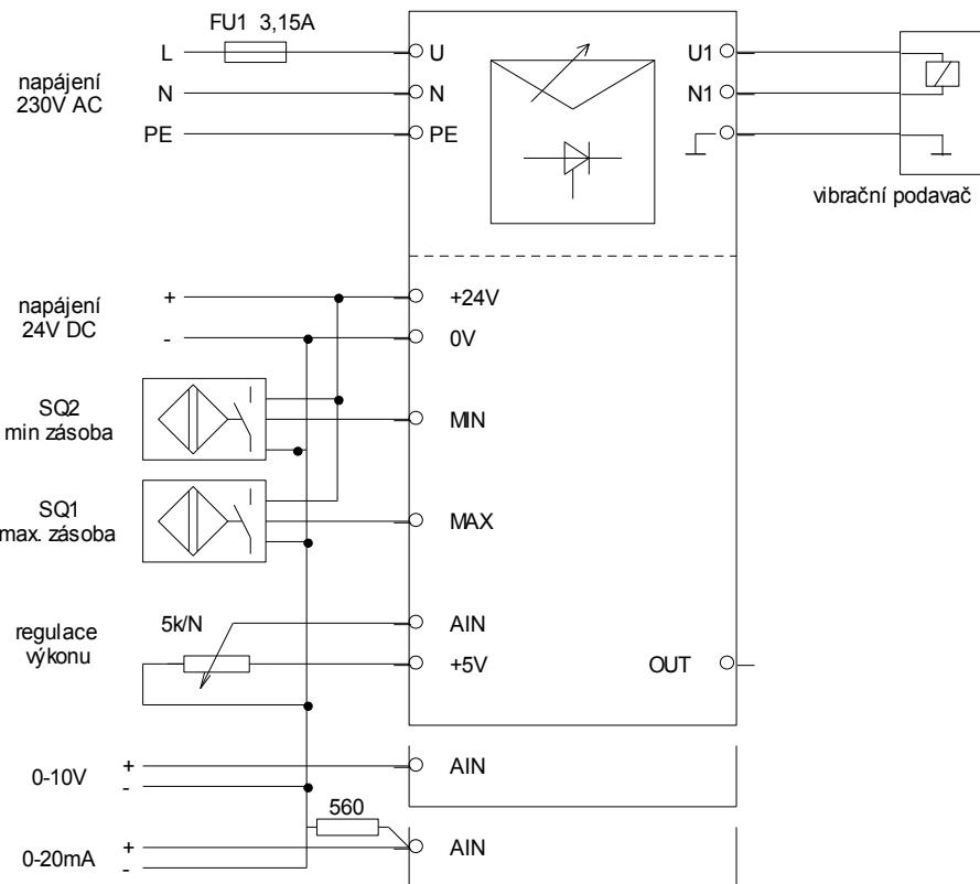
obr. 3 - zapojení externího výkonového modulu
