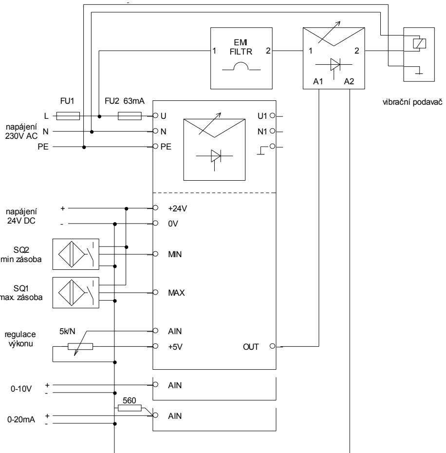
obr. 4 - zapojení externího výkonového modulu
